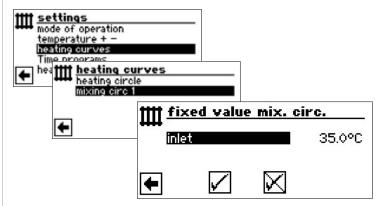
Ist die Option "Festtemperatur" durch die Systemeinstellung eingeschaltet, wechselt der Bildschirm in das Menü "Heizkurven" (von dem ausgehend Sie in die Menüs "Festwert Mischkr. 1" gelangen)
